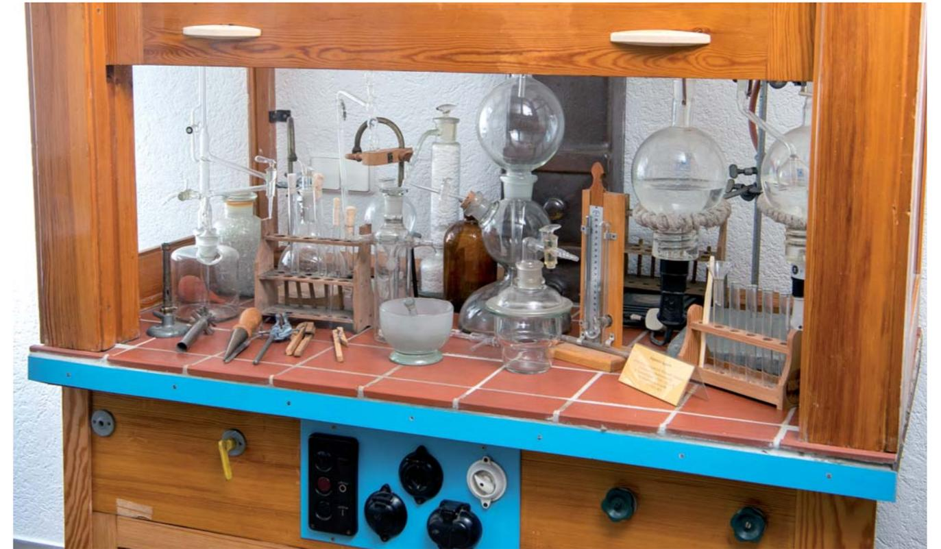
Bei bestimmten chemischen Reaktionen können Gase entstehen. Chemische Arbeitsplätze befinden sich daher oft unter Abzügen wie diesem aus der Zeit um 1950. Sie saugen Gase, Stäube und Aerosole schnell ab und schützen die experimentierende Person davor, die Stoffe einzuatmen.
