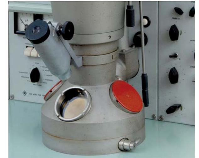
Elektronenmikroskopen gelingt es ungleich höhere Vergrößerungen als Lichtmikroskopen, weil sie mit Elektronenstrahlen funktionieren, deren Wellenlänge 100.000fach geringer ist als die von sichtbarem Licht. Sie sind dadurch unverzichtbare Instrumente für die Anatomie und Histologie geworden. Subzelluläre Strukturen und Viren sind nur mit Elektronenmikroskopen sichtbar zu machen, weil Lichtmikroskope nicht die dafür nötige Auflösung erreichen.
