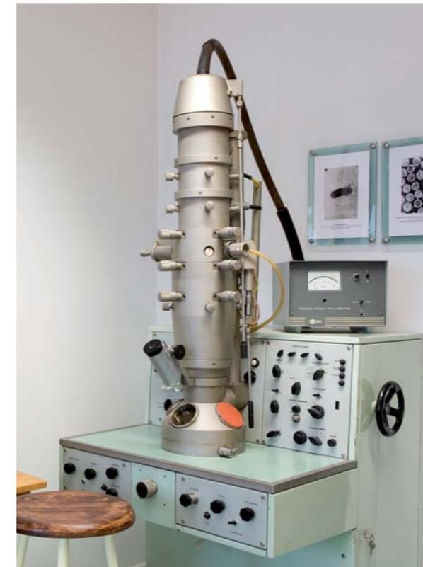
Dieses Elektronenmikroskop des Werkes für Fernseh-elektronik Berlin stammt aus dem Jahr 1966. Es verfügt über ein Auflösungsvermögen von etwa einem Nanometer. Durch elektronenoptische und lichteoptische Nachvergrößerungen erreicht es eine bis zu einer millionenfachen Gesamtvergrößerung.
