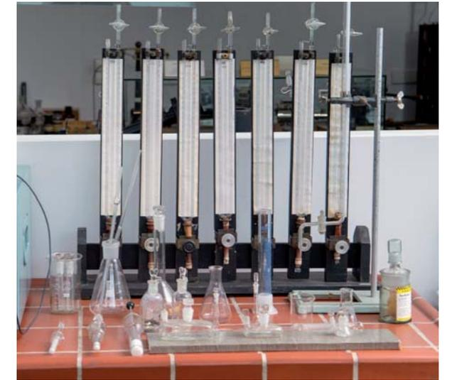
Manometer sind Geräte, mit denen sich der Druck eines Gases messen lässt. In den 1920er Jahren kombinierten Otto Warburg und Erwin Negelein sie mit Gefäßen, in denen biochemische Reaktionen stattfanden. So gelang es ihnen, den Gasstoffwechsel von Geweben und Zellen zu bestimmen, beispielsweise wie viel Sauerstoff bei einer Reaktion verbraucht oder wie viel Kohlendioxid dabei gebildet wurde. Dieses manometrische Gerät wird daher auch als Warburg-Apparat bezeichnet.
