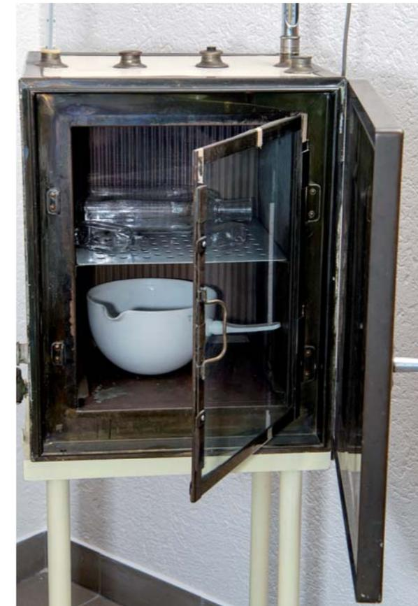
Biologische Entwicklungs- und Wachstumsprozesse sind an spezielle Bedingungen gebunden. Inkubatoren oder Brutschränke dienen dazu, solche Mikroklimas zu schaffen und zu erhalten, indem Luftfeuchtigkeits- und Temperatur-Bedingungen eng geregelt werden.
